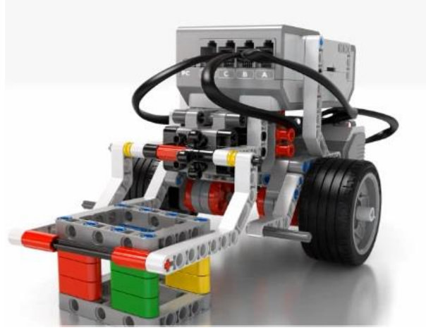
Resim 13. Robot Kolunun Kutuyu (LEGO Parçasını) Taşınması
